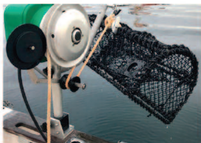
Teinehaling på aluminiumskive med to kilspor, kort bom og presshjul.
